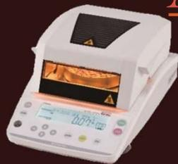
内蔵のハロゲンヒータでサンプルを加熱し、簡単・正確に水分率を求めることが出来ます。乾燥機による乾燥減量法よりも短時間で測定可能。各種アプリケーションやデモ機もご用意。
